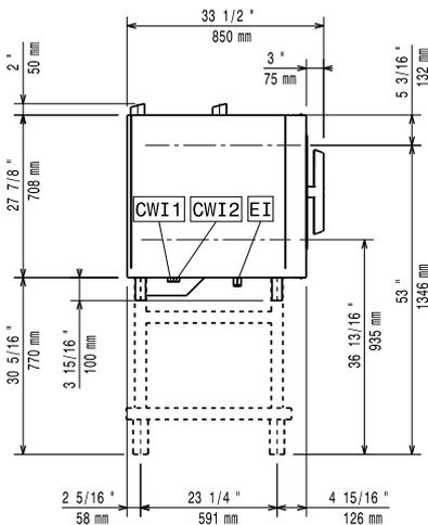
CWI1 = Raccordement eau froide      EI = Connexion électrique
